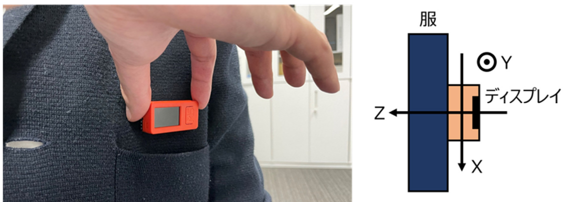
図1 センサの装着の様子（X:鉛直下向き、Y:紙面から突き出る方向、Z:衣服の方向）
